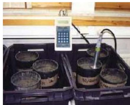
Рисунок 6.1 Испытания методом всасывающей трубки
