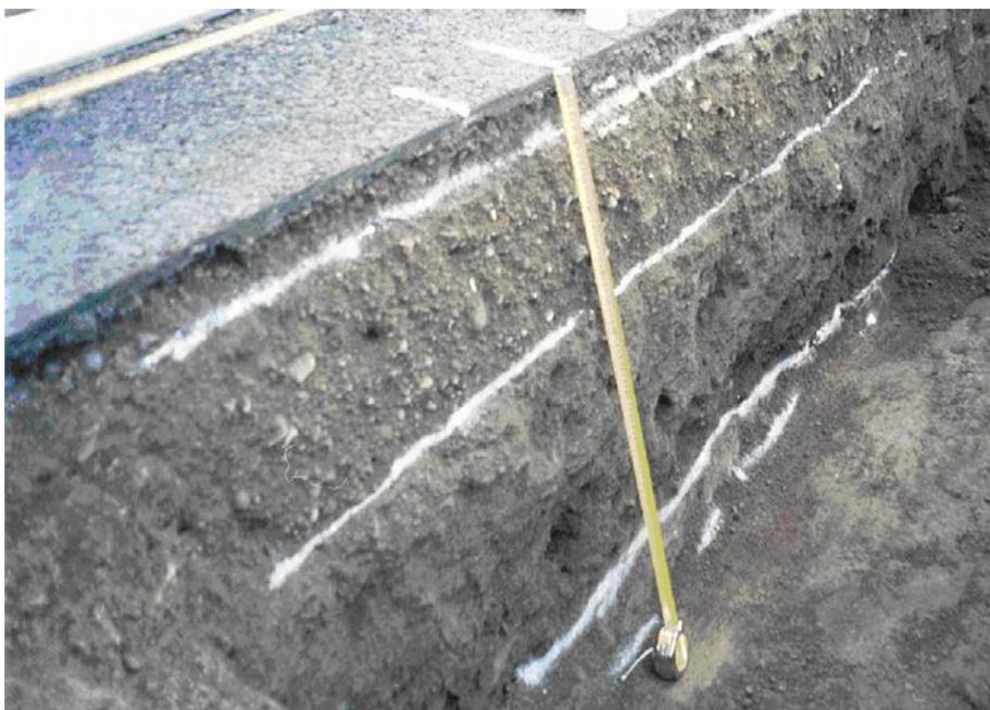
**Рисунок 1.1** Поперечный профиль дорожной одежды с тонкослойным чернощебеночным покрытием (границы слоев помечены краской-спреем) (правообладатель фото: С. Эрлингссон)
