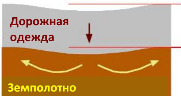
Рисунок 2.10. Стадия колейности 2 – деформации сдвига в основании и зернистый материал, повторяющий форму основания
