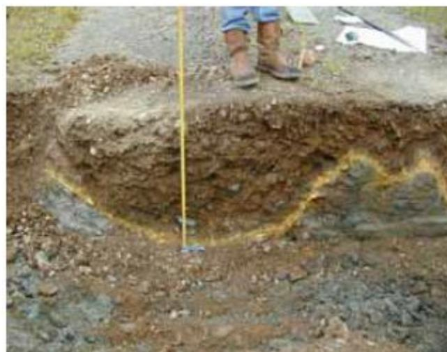
Рисунок 2.11. Ярко выраженная колейность 2 степени, показанная в поперечном сечении покрытия на очень слабом основании (фото: В. Тиррелл)
