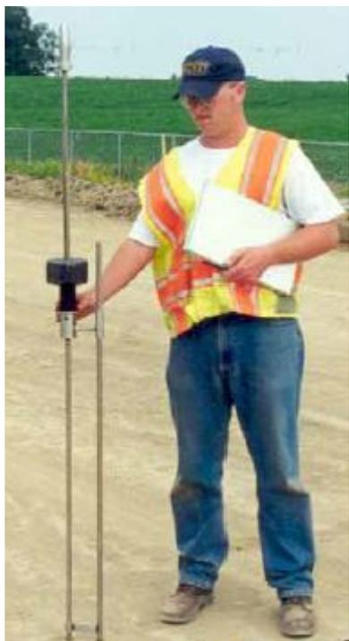
Рисунок 6.3 Динамический конусный пенетrometer (DCP)
