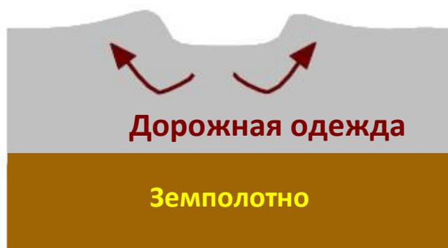
Рисунок 2.6. Стадия колеиности 1 – Деформации сдвига в гравийном покрытии, близко к поверхности.
