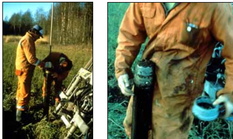
Figur 4.1 Fotografi på Svenska Geotekniska Institutets provtagare som används.
