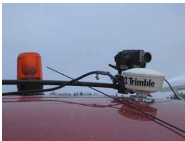
Figur 4.2. Digital video og GPS installeret på en GPR opmålings bil.
