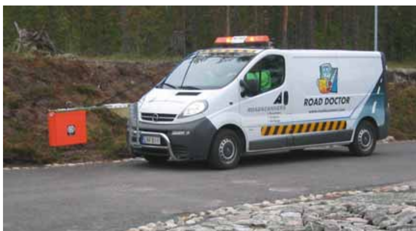
Figur 4.3. GPR målebilen med 1 GHz horn antenner monteret på fronten.
