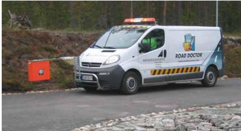
Figure 4.3. Maatutkamittausauto, jonka eteen kiinnitetty 1 GHz ilmapasteantenni.
