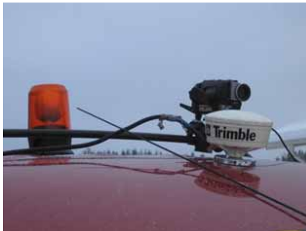
Kuva 4.2. Digitaalinen videokamera ja maatutkalaitteisto asennettuna maatutkaluotausautoon.
