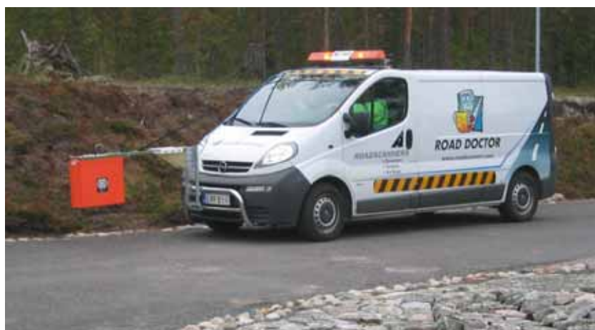
Figur 4.3. GPR-mätbil med 1 GHz hornantenn i fronten.
