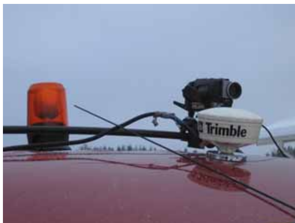
Figur 4.2. Digital video och GPS installerade på GPR-mätbilen.
