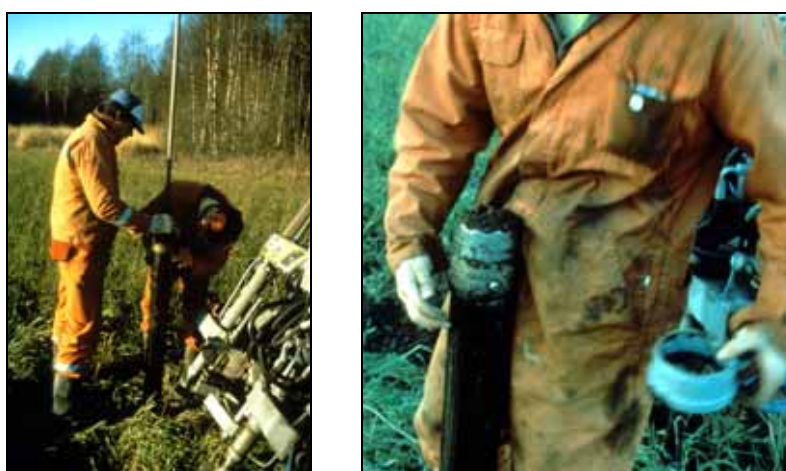
Kuva 4.1 Kuvia Ruotsin geoteknisen instituutin näytteenottimen käytöstä.
